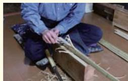
④カンナを使って「合わせ」の作業を行います。4枚の竹が隙間なく合わさるよう、断面の角度を整え、滑らかに仕上げます。
